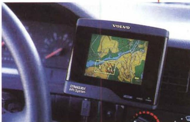
Fig. 16: Eccellente anche il sistema Dynaguide di informazione dinamica sulle condizioni del traffico e di pianificazione dei tragitti.
